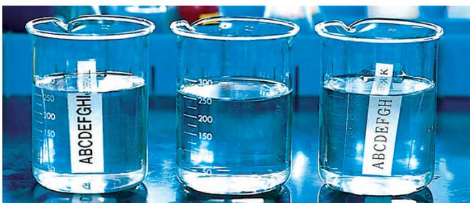
Test de résistance aux produits chimiques et à l'eau, les étiquettes ont été plongées dans l'eau et divers produits chimiques pendant 2 heures.
