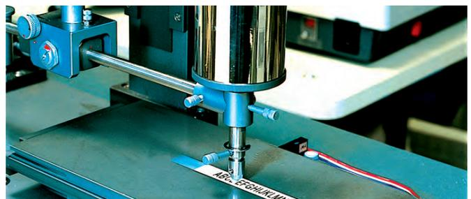
Test de l'abrasion: L'étiquette a été poncée 50 fois avec un poids équivalent à 1 kilos.
