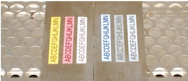
Résistance aux températures : Les étiquettes laminées ont été soumises à des températures allant de  $-80^{\circ}\text{C}$  à  $+150^{\circ}\text{C}$  pendant 240 heures, et le texte n'a pas été affecté.
