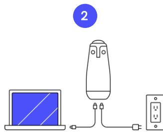
2 Branchez l'alimentation. Connectez le câble USB-C à un ordinateur de bureau installé dans la salle ou à un ordinateur portable.
