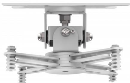
Le Techmount est un support de plafond de projecteur universel conçu pour fixer solidement 99 % des vidéoprojecteurs aux plafonds. Il est conçu pour les applications dans lesquelles aucun « repli » n'est nécessaire, donc aucune perche n'est incluse. Il maintient le projecteur à 110 mm du plafond.
